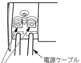
電源ケーブルが抜けないように確実にねじ止め
