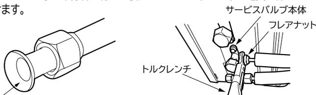
フレア内面のみ冷凍機油(市販品)をごくわずかに塗布してください。
