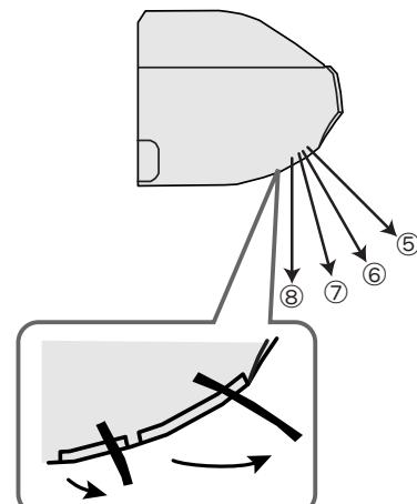
\*上下風向板は、閉じた状態より矢印の方向に動作します。
