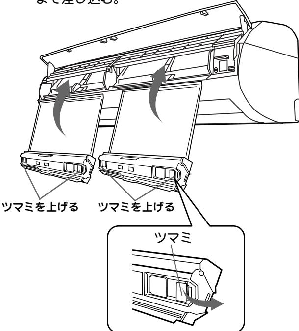
②ダストボックスを取り付け、左右2ヵ所のツマミを内側に倒す。
