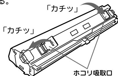
●ホコリ吸取口のフタは確実に閉めてください。フタが開いたままダストボックスを装着してフィルター オートクリーンを動作させると、ホコリが出てくることがあります。
