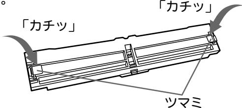
●ダストボックスを組んだときは、確実にツマミを倒してください。ツマミが外れた状態で本体に取り付けた場合は、フィルターオートクリーンが動作しません。
