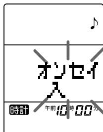
ドット表示部に現在設定されている状態が点滅します。
