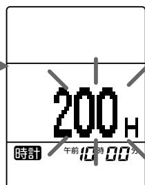
ドット表示部に現在設定されている動作時間が点滅します。
