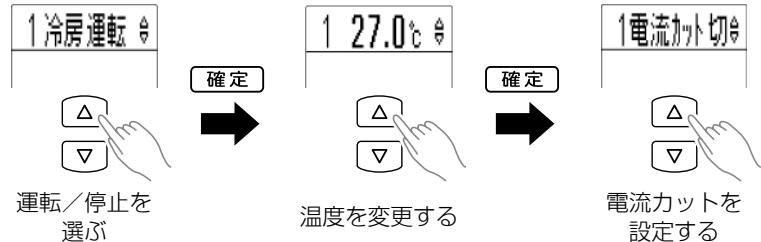
電流カットを設定して [確定] を押すと、操作された室内ユニットの受信音が鳴り、お知らせランプ（黄）が点灯します。
