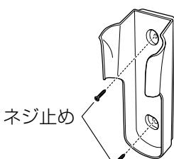
付属のネジ2本で、リモコンホルダーを固定する。
