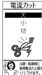
※「大」に設定していても、自動霜取り運転時 → 51ページ、外気温が高いとき(約40°C以上)、または室外ユニットが運転開始後約80秒間の使用電流の上限は、「小」と同じになります。
