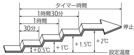
おやすみタイマーを設定すると、30分ごとに設定温度が1°Cずつ下がります。合計4°C下がった時点で、その温度を保ち、設定した時間後に自動的に運転を停止します。
