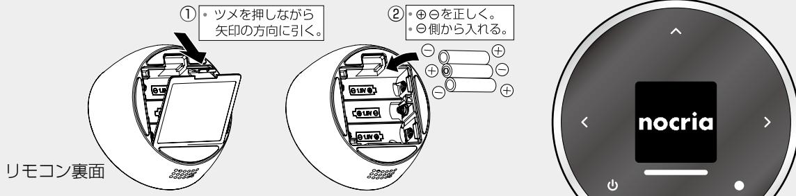
電池を入れるとリモコンが起動して、接続のための操作内容が画面に表示されます。
