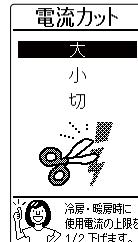
※「大」に設定していても、自動霜取り運転時 → 49ページ、外気温が高いとき(約40°C以上)、または室外ユニットが運転開始後約80秒間の使用電流の上限は、「小」と同じになります。
