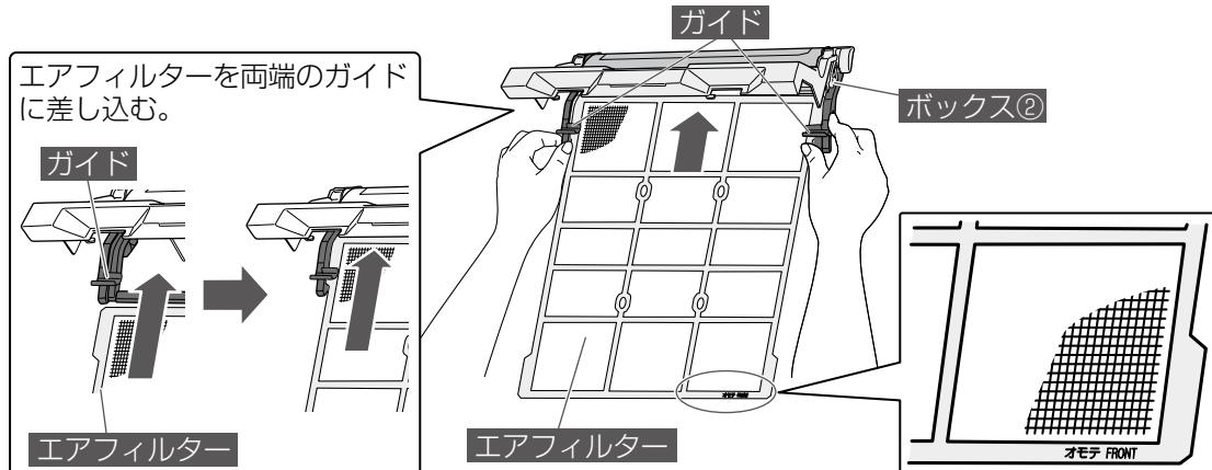
3 エアフィルターの下端をボックス②左右の▷ ◁ 印に合わせます。
