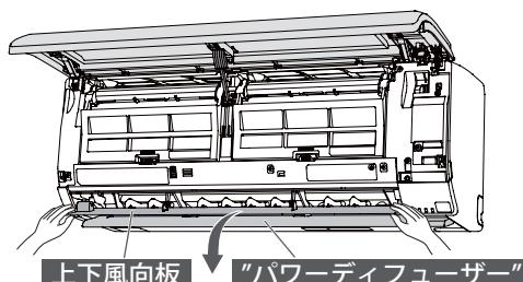
※ 無理に強い力を加えると、上下風向板・"パワーディフューザー"が破損したり内部の部品が故障したりするおそれがあります。
