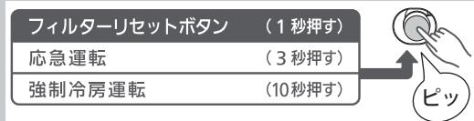
●クリーンランプ(黄)が消灯し、お手入れ時期の目安となる積算運転時間がリセットされます。
