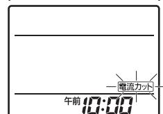
※「電流カット」表示が点灯します。
