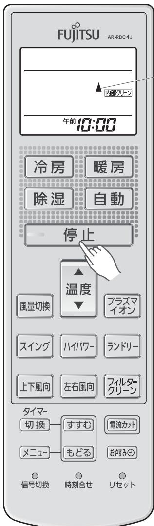
(例) 冷房運転を停止し、内部クリーン運転を開始したとき
