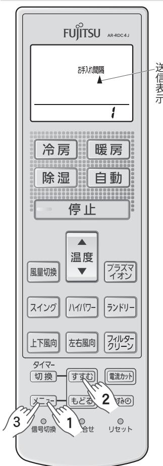
(例) フィルタークリーン動作間隔を「1(短め)」に設定した場合
