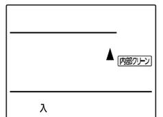
▶ 内部クリーンを設定すると、リモコン表示部に **内部クリーン** が表示されます。
