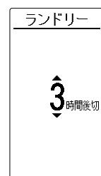
時間を合わせて少し待つと、信号が送信され、本体の運転ランプ（緑）とタイマーランプ（橙）が点灯し、ランドリー運転が開始されます。
