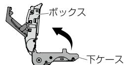
下ケース両端のガイドの間にエアフィルターの「オモテ面」を上にして、差し込む。
