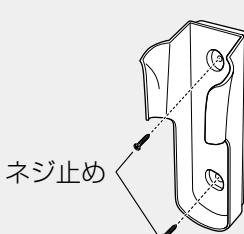
付属のネジ2本で、リモコンホルダーを固定する。
