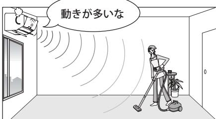
人感センサーで検知した人の動き（多い少ない）やお部屋の温度に応じて、設定温度を自動的に制御し、快適・省エネ運転をする機能です。
