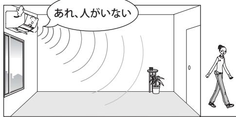
お部屋に人がいない状態が続いたら、設定温度を自動で控えめに制御し、ムダな電気代を抑えた運転を行う機能です。
