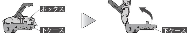
②下ケース左右のガイドの間にエアフィルターの「オモテ」側を上（ボックス）側にして、矢印の方向に差し込む。
