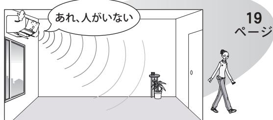
お部屋に人がいない状態が続いたら、設定温度を自動で控えめに制御し、ムダな電気代を抑えた運転を行う機能です。
