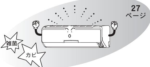
室内ユニット内部(熱交換器、送風ファン、送風路)を乾燥させ、カビや雑菌の繁殖を抑えます。
