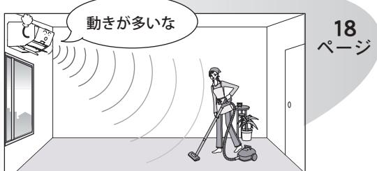
人感センサーで検知した人の動き（多い少ない）やお部屋の湿度に応じて、設定温度を自動的に制御し、快適・省エネ運転をする機能です。
