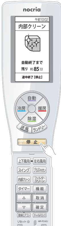
(例)冷房運転を停止し、内部クリーン運転を開始した場合
