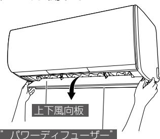
※ 無理に強い力を加えると、上下風向板・"パワーディフューザー"が破損したり内部の部品が故障したりするおそれがあります。
