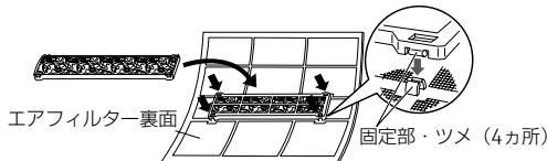
④エアフィルター（2枚）を取り付け、吸込グリルを閉めます。
