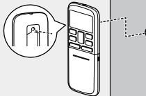
リモコン取付け用ネジを柱や壁に取り付け、リモコン背面のへこみに取り付ける
