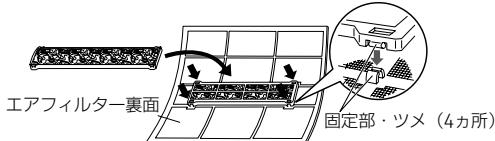
④エアフィルター（2枚）を取り付け、吸込グリルを閉めます。
