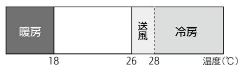
お部屋の温度が26°C以上になると、状況に適した運転を開始します。お部屋の温度が18°C以下になると、暖房を開始します。
