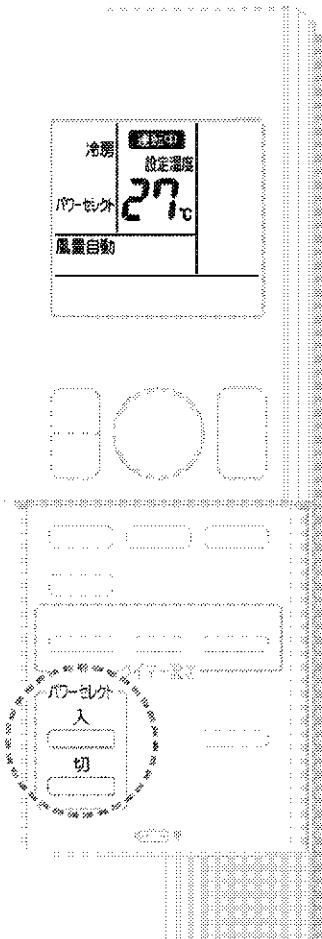
運転時の電流を制限して<sup>\*</sup>、電力消費を抑える機能です。
