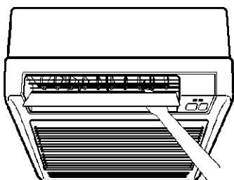
すみずみルーバー(左右風向調節羽根)のツマミを持って調節してください。
