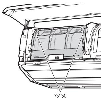
7 補助ダストボックスとダストボックスを取り付ける。▶39ページ
