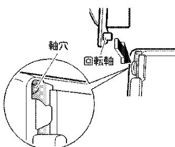
**2** 前面パネルをゆっくり閉じ、両端を押した後、中央を押す。
