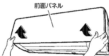
**3** 前面パネルをさらに開きながら左側へスライドし、手前に引いて左側の回転軸を外す。同様に右側の軸も外す。
