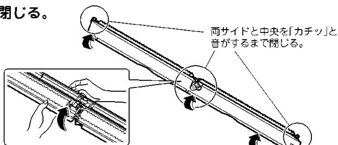
3 ダストボックスを両手で持ち、両側のくぼみに合わせて挿入し、押し込んで取り付ける。
