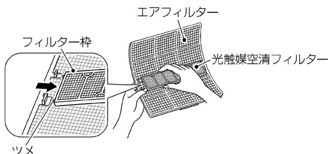
**4** 光触媒空清フィルターとエアフィルターをもとどおり取り付け、前面パネルを閉じる。
