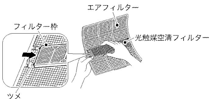
**4** 光触媒空清フィルターとエアフィルターをもとどおり取付け、前面パネルを閉じる。
