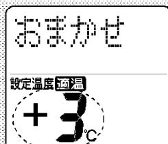
適温(室内、屋外温度から決定した温度)より約3°C高めの温度を表します。
