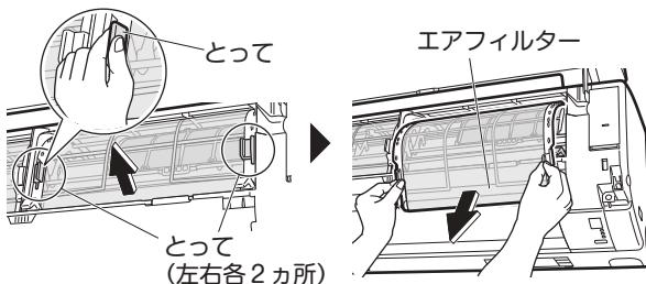
エアフィルターを取り付けずに運転したり、傷ついた状態で運転しないでください。故障の原因となります。
