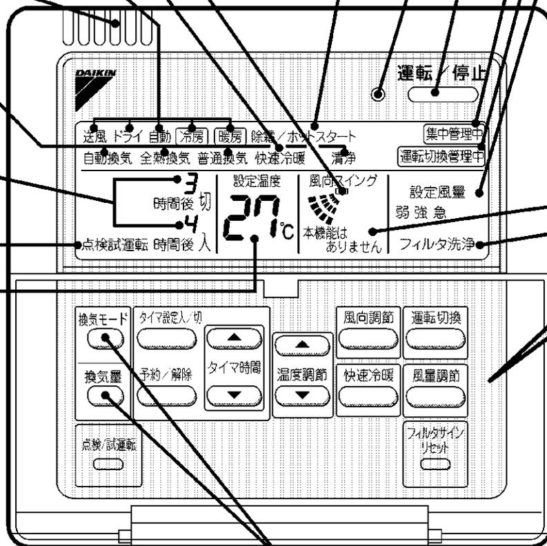
全熱交換器ユニット「ベンティエール」など接続時に使用します。詳しくは全熱交換器ユニットの取扱説明書を参照してください。
