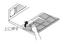
③吸込グリルのとってを持ち、吹出口側に押してください。 吸込グリルが確実に固定されていることを確認してください。
