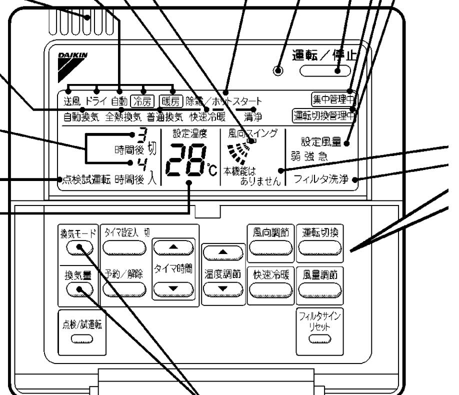
全熱交換器ユニット「ベンティエール」など接続時に使用します。
