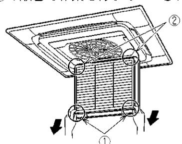
①エアフィルターの端部をななめ下に引いてグリル突起部からエアフィルターの引っ掛け穴部を外してください。(左右共)
