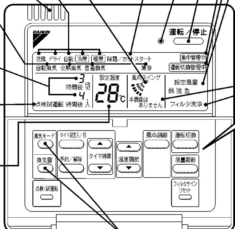
全熱交換器ユニット「ベンティエール」など接続時に使用します。詳しくは全熱交換器ユニットの取扱説明書をご覧ください。
