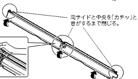
**3** ダストボックスを両手で持ち、両側のくぼみに合わせて挿入し、押し込んで取り付ける。
