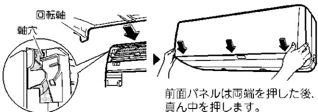
前面パネルを閉じて、電源プラグをコンセントに差し込む、またはブレーカーを入れてください。フラップが一度開き、また閉します。
