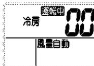
**2** リモコンを室内ユニットに向けたまま「取消」を連続で押して「ピーッ」と鳴ったときのエラーコードを確認し、下表の操作と対応を行ってください。
