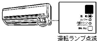
運転ランプが点滅するときは、電源プラグを抜く、またはブレーカーを切り、約1分後、もう一度電源を入れ、運転を行ってください。
