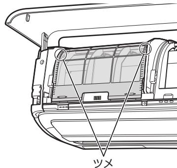
7 補助ダストボックスとダストボックスを取り付ける。▶47ページ
