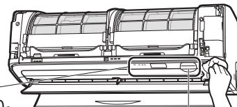
人感センサー、床温度センサーを手で回さないでください。
