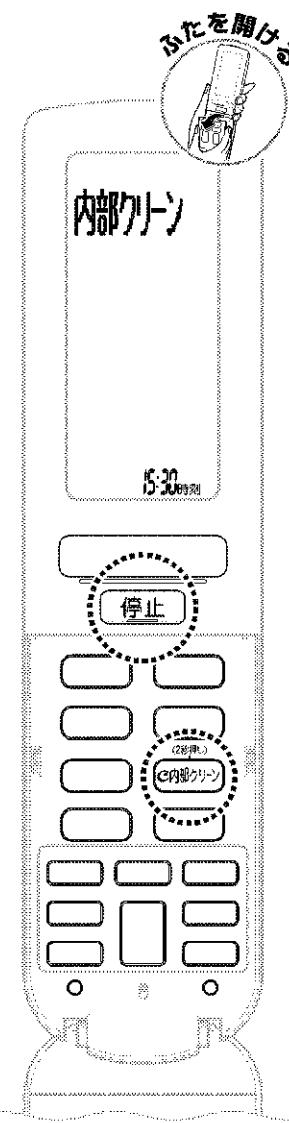
冷房・除湿・除湿冷房運転を行うと、エアコン内部が結露し、カビやニオイが発生する原因になります。内部クリーン運転でエアコン内部を乾燥させることをおすすめします。
