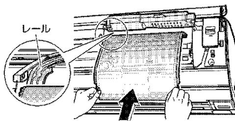
**2** フィルター押え枠(黄色)を「カチッ」と音がするまで押し上げる。
