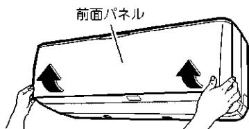
**2** 前面パネルをさらに開きながらパネルを左側へスライドし、手前に引いて左側の回転軸を外す。同様に右側の軸も外す。
