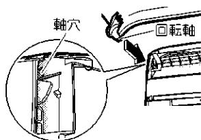
**2** 前面パネルをゆっくり閉じ、両端を押した後、中央を押す。
