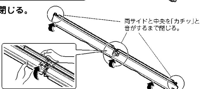
3 ダストボックスを両手で持ち、両側のくぼみに合わせて挿入し、押し込んで取り付ける。
