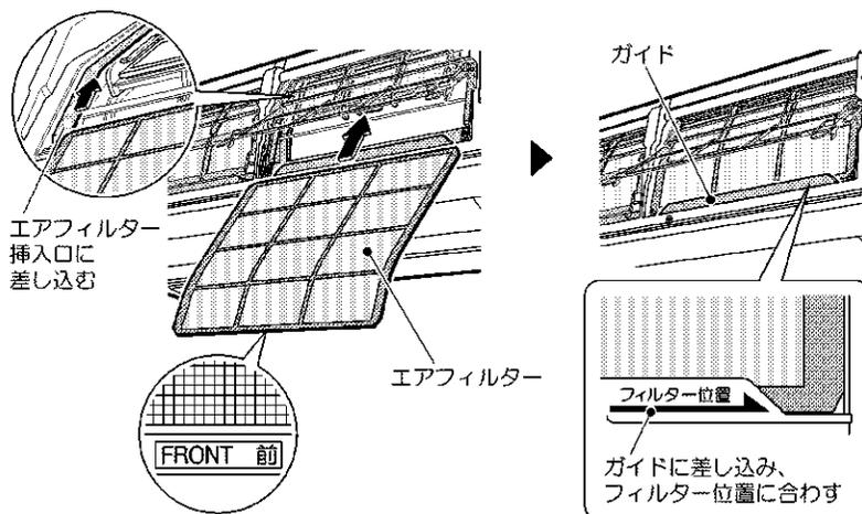
3 フィルター押え枠を閉じ、黄色の固定ツマミ(2カ所)
