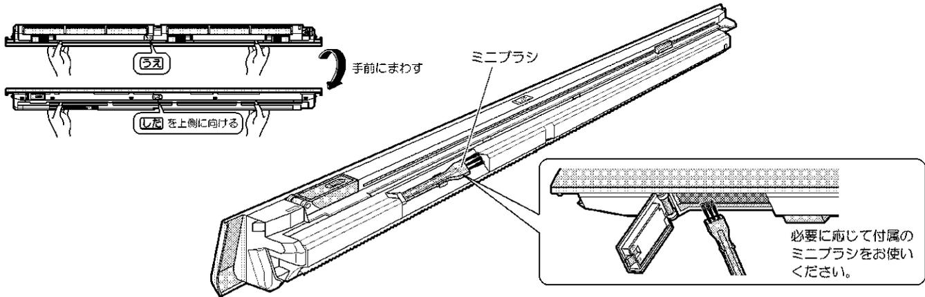
**1** 部 (左右2カ所・中央1カ所) を解除側へスライドさせ、ダストボックスを開ける。
