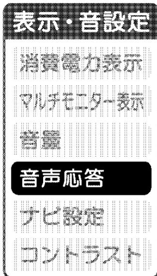
**音声応答** 音声応答の入切を設定します。「入」に設定すると、リモコンで設定した内容や運転状態を室内ユニットから音声でお知らせします。
