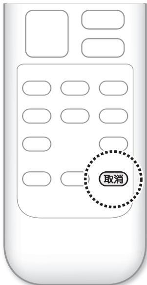
運転ランプが点滅するときは、異常をお知らせしています。電源プラグを抜くか、ブレーカーを切り、約1分後、もう一度電源を入れて運転してください。
