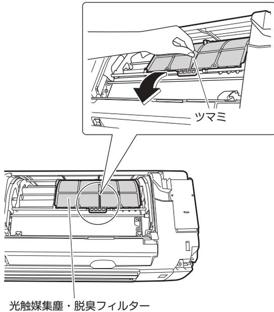
4 ツマミを持ち脱臭フィルター枠の四隅をしっかりと固定部に取り付ける。
