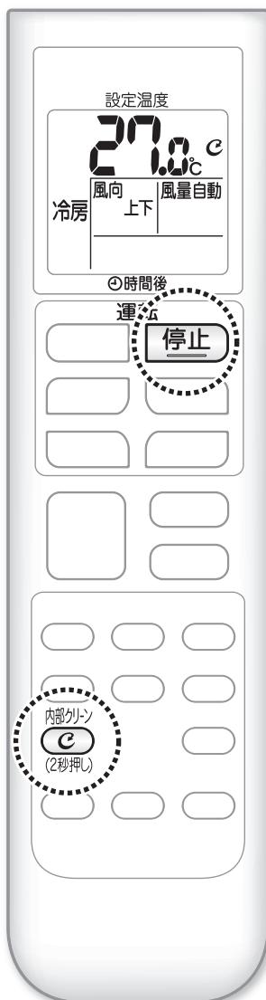
冷房・除湿運転を行うと、エアコン内部が結露し、カビやニオイが発生する原因になります。内部クリーン運転でエアコン内部を乾燥させることをおすすめします。
