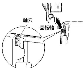
6 前面パネルをゆっくり閉じ、両端を押した後、中央を押す。
