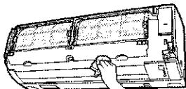
5 前面パネルの左右の回転軸を室内ユニットの軸穴に合わせて取り付ける。
