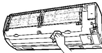
**5** 前面パネルの左右の回転軸を室内ユニットの軸穴に合わせて取り付け。
