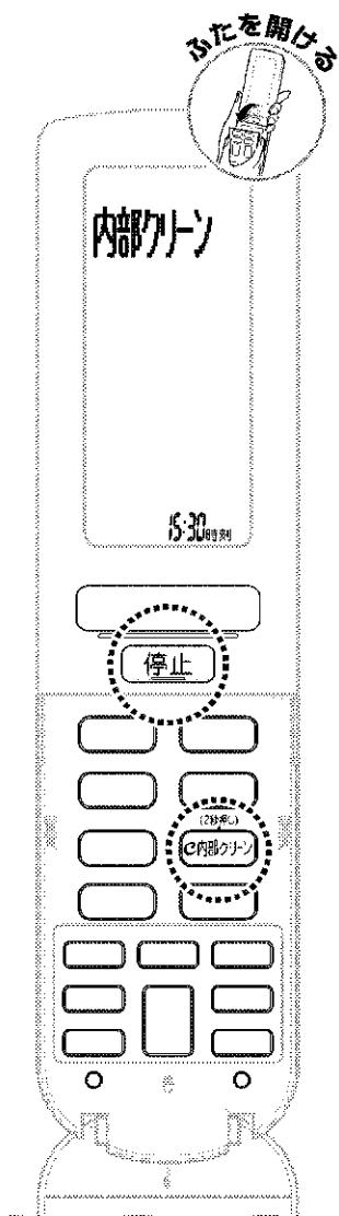
冷房・除湿・除湿冷房運転を行うと、エアコン内部が結露し、カビやニオイが発生する原因になります。内部クリーン運転でエアコン内部を乾燥させることをおすすめします。
