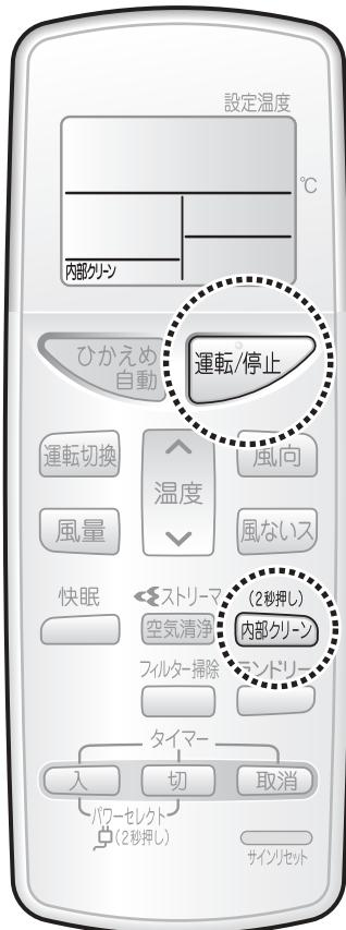
ドライ、冷房運転を行うと、エアコン内部が結露し、カビやニオイが発生する原因になります。内部クリーン運転でエアコン内部を乾燥させることをおすすめします。
