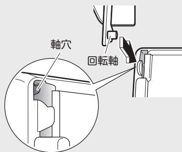
2 前面パネルをゆっくり閉じ、両端を押した後、中央を押す。
