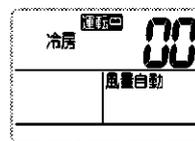
**2** リモコンを室内ユニットに向けたまま **取消** を連続で押して「ピー♪」と鳴ったときのエラーコードを確認し、下表の操作と対応を行ってください。
