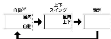
※風向自動は快適自動運転のみに使用できます。運転モードに合わせ自動でフラップ位置を調整します。
