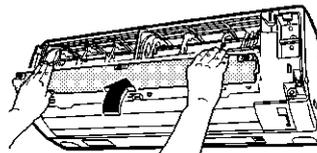
固定ツマミ(左右2カ所)をロック側にする。確実に固定されていないと正常にフィルター掃除運転を行いません。
