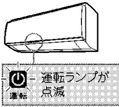
運転ランプが点滅するとき（内部クリーン運転中は除く）は、電源プラグを抜く、またはブレーカーを切り、もう一度電源を入れ運転を行ってください。
