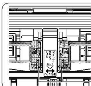
フィルター押え枠(黄色)の下端をロック位置【↔】に合わせてください。フィルター押え枠の固定ツマミ(左右各2カ所)を閉じる際は、押え枠が浮かないよう押さえつけながら、「カチッ」と音がするまで下げてください。ロックがされていないと、フィルター掃除運転中にフィルターが引っ掛かり正常にフィルター掃除運転を行いません。
