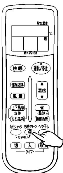
① 晴れた日に内部クリーン運転をして、内部をよく乾燥させる。
