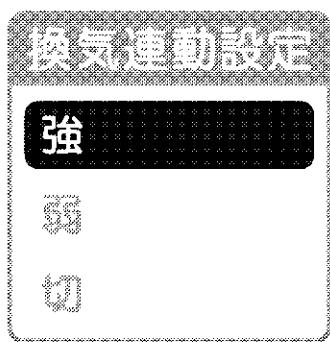
**換気連動設定** 冷房、暖房などの運転中に換気運転を連動させることができます。
