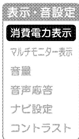
**消費電力表示** 室内ユニットの消費電力累積値がリセットされ、消費電力表示が0kWhにリセットされます。
