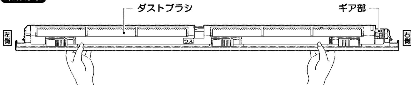
1 ダストボックスの **うえ** を上側に向けて、ダストボックスの左側を合わせる。
