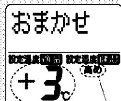
適温(室内、屋外温度から決定した温度)より約3°C高めの温度を表します。
