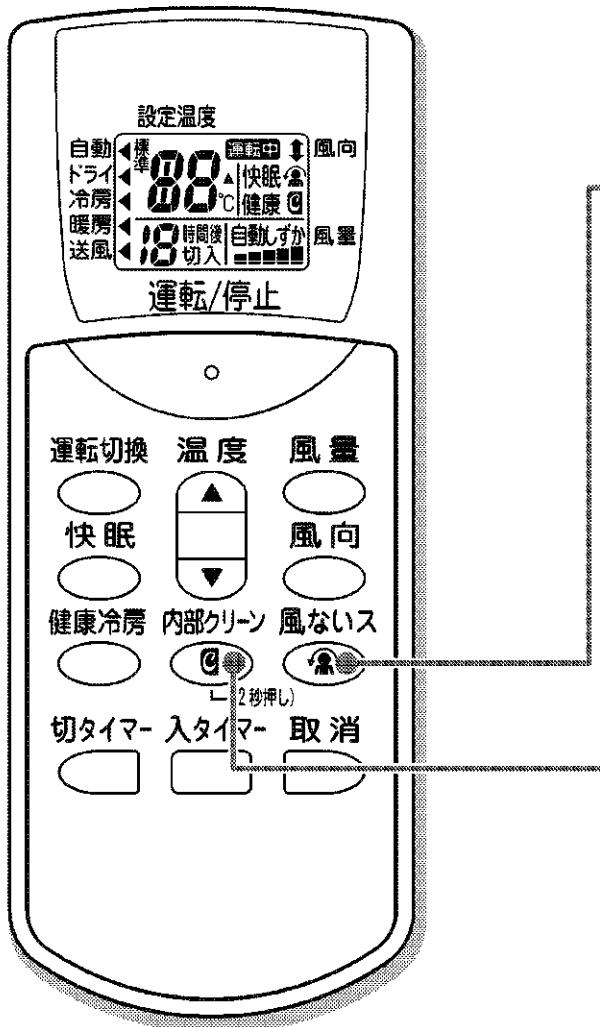
風向と風量を調節するボタンは、リモコンの馬印マークが表示される方に
