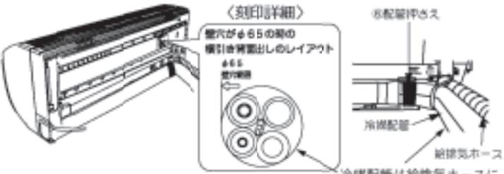
冷媒配管は給排気ホースに接するように曲げ、刻印と同じレイアウトしてください。
