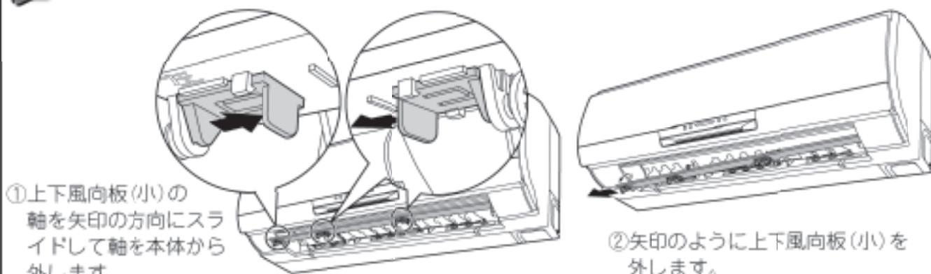
①上下風向板(小)の軸を矢印の方向にスライドして軸を本体から外します。
