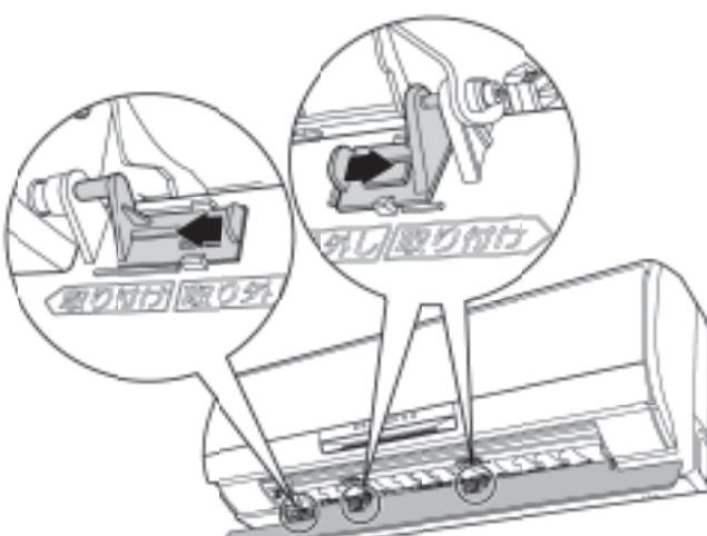
②上下風向板(大)の軸を矢印の方向にスライドして本体へ取り付けます。
