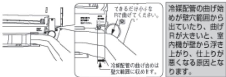
冷媒配管の曲げ始めが壁穴範囲から出ていると、曲げRが大きいと、室内機が壁から浮き上がり、仕上りが悪くなる原因となります。
