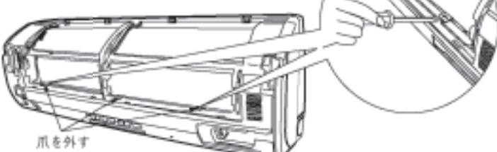
⑤化粧カバー両側面に手をかけ、矢印のように引きながら取り外します。
