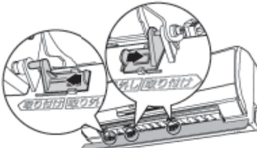
①本体にある軸(正方形)に上下風向板(大)の右側の正方形の穴を矢印のように差し込みます。
