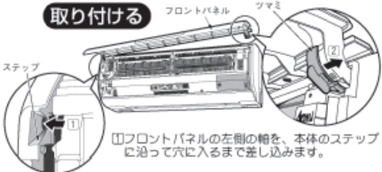
①フロントパネルの左側の軸を、本体のステップに沿って穴に入るまで差し込みます。
