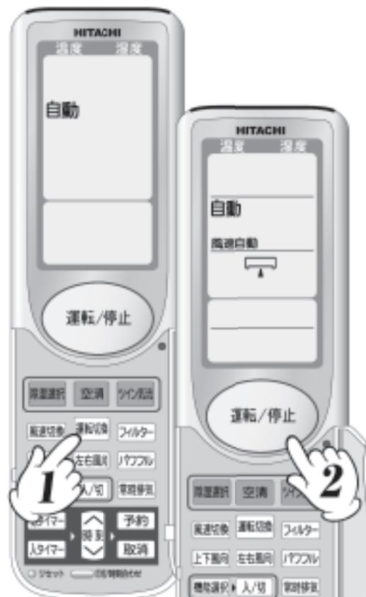
**1** 運転切換ボタンを押して、運転の種類を“自動”に設定する
