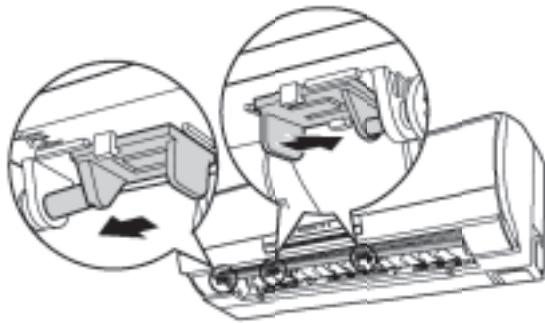
①本体にある軸(長方形)に上下風向板の右側のキー溝を矢印のように差し込みます。このときレバーがある面を下向きにしてください。
