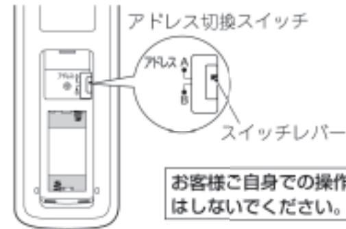
※アドレス切換スイッチは、2台の室内機を同じ部屋に据え付けたときなど、リモコンの混信を防ぎたいときに使用しますので、通常は使用しません。(工場出荷時は「A」側に設定されています。)
