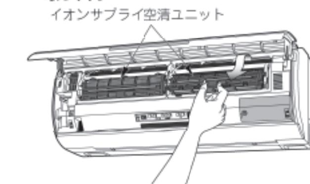
• イオンサプライ空清ユニット(2個)を上に上げながら手前に引いて取り外します。
