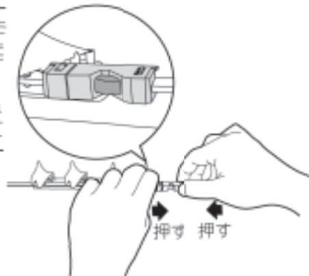
③ジョイント部を持ち、矢印方向に「カチッ」と音がするまで押し込んで連結させてください。
