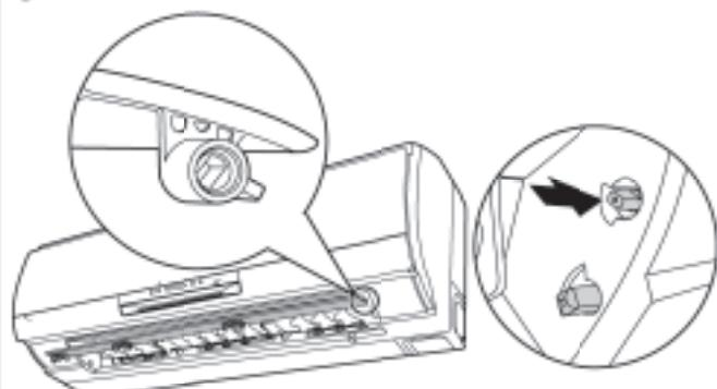
①本体にある軸(長方形)に上下風向板の右側のキー溝を矢印のように差し込みます。
