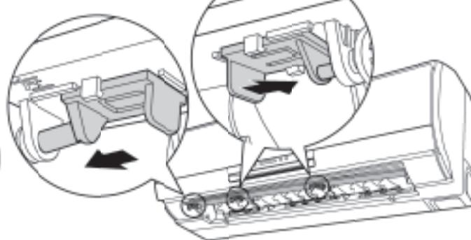
②上下風向板(小)の軸を矢印の方向にスライドして本体へ取り付けます。
