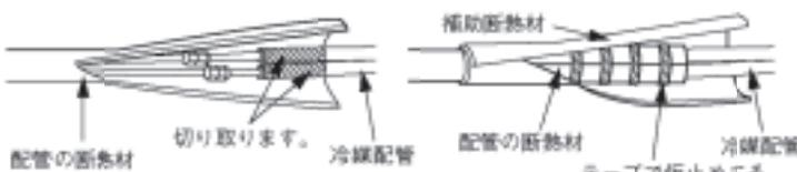
④冷媒配管を壁穴位置に合わせて整形します。
