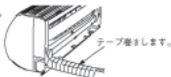
●既設の壁穴がずれている場合、室内機の背面を通す部分の給排気ホースはホース用断熱材で割りを上にして覆い、隙間のないようにテープ巻きします。
