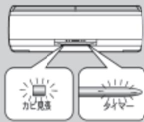
(電源プラグを抜く前に、リモコンを室内機に向けて ボタンを押してから ボタンを押すとリモコンに数字が表示されます。この数字で故障原因がわかりますので、リモコンに表示された数字をご確認の上ご連絡ください。また、リモコンに数字が表示されない場合には、点滅回数でも故障原因がわかりますので、ランプの点滅回数をご確認の上ご連絡ください。)
