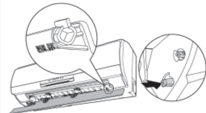
①本体にある軸(正方形)に上下風向板(大)の右側の正方形の穴を矢印のように差し込みます。
