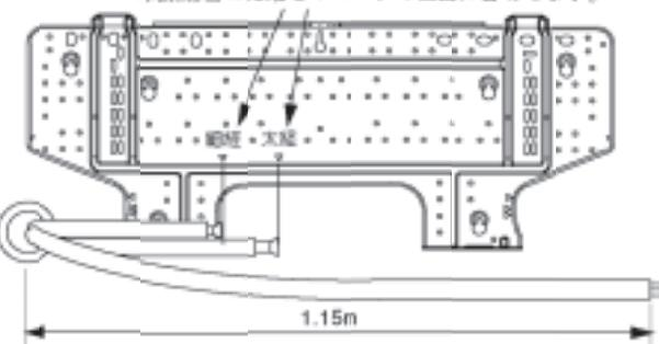
できるだけ小さなRで曲げてください。(ポリシンを使用すると配管を済さずに小さなRで曲げることができます。)
